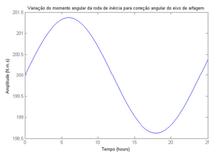
Varição do momento angular da roda de inércia para correção angular do eixo de arfagem
